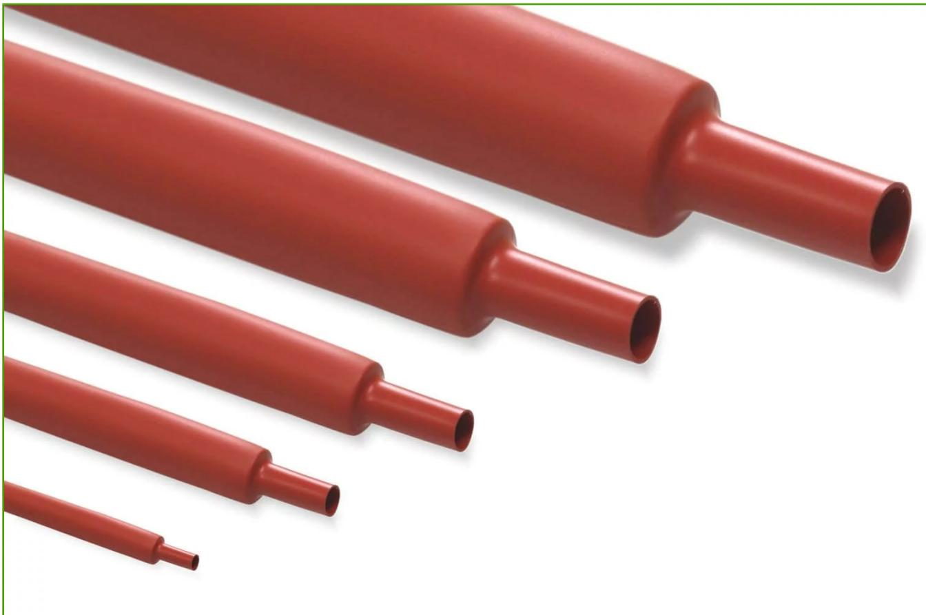
NOTE: Autoestinguente; MATERIALE: poliolefina reticolata; TEMPERATURA D'ESERCIZIO: da -55°C a + 135°C; TEMPERATURA DI RESTRINGIMENTO: + 90°C
